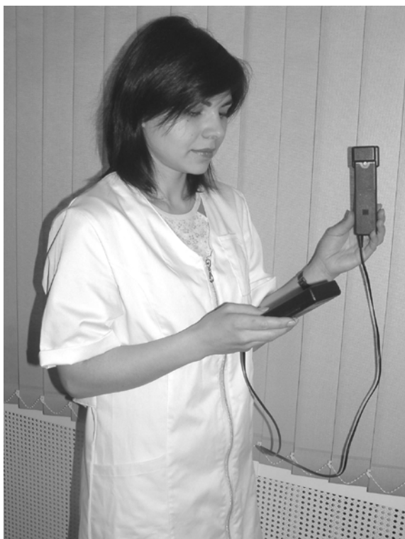
Рис. 2. Измерение освещенности в помещении со светозащитными устройствами
