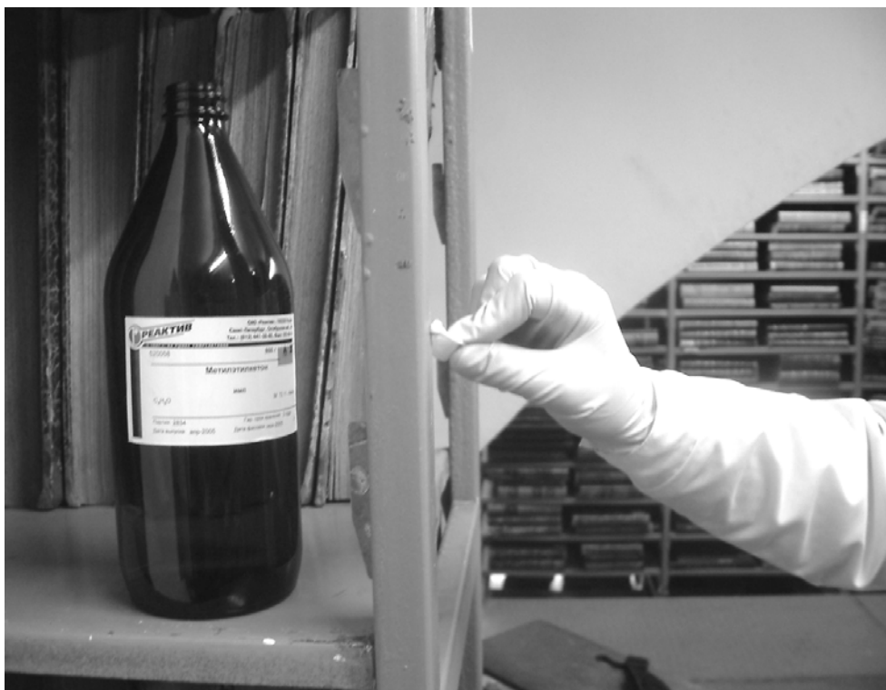
Рис. 1. Проверка правильности нанесения покрытия на стеллаж с использованием органического растворителя метилэтилкетона (МЭК)
