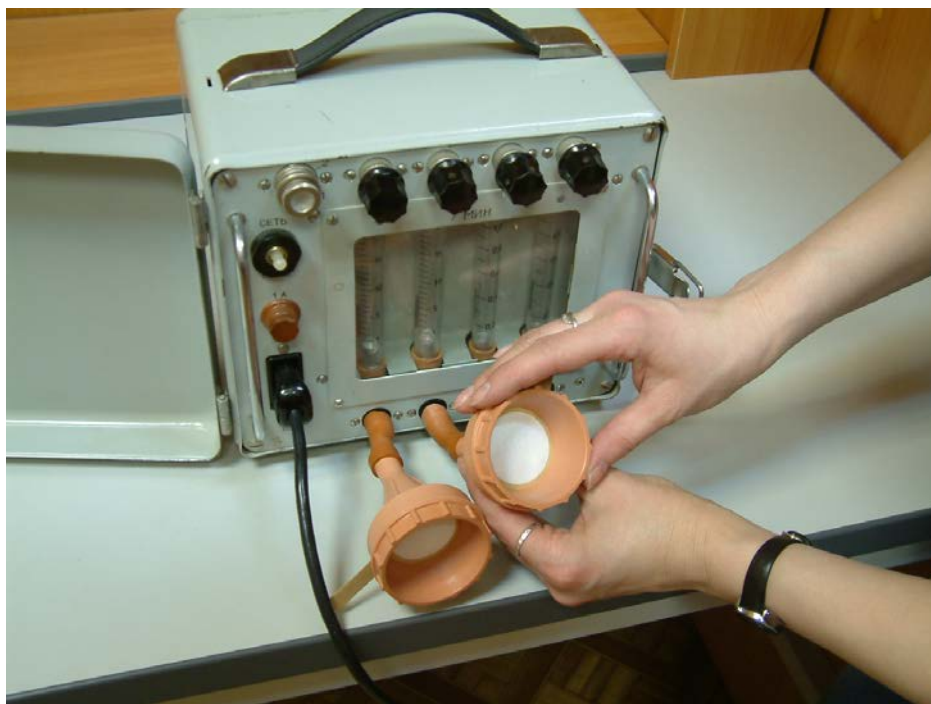
Рис. 4. Соединение фильтров с аспиратором
