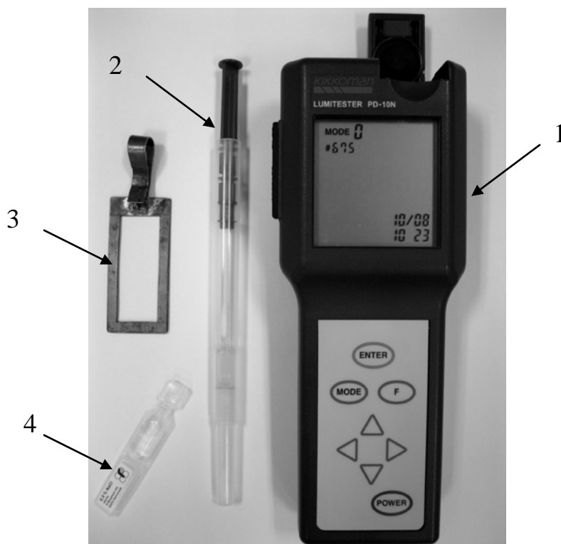
Рис. 1. Материалы для отбора проб билюминесцентным методом: 1 — люминометр Lumitester PD 10N; 2 — свабы с реагентом LuciPac W; 3 — ампула стерильного изотонического раствора; 4 — рамка с фиксированной площадью
