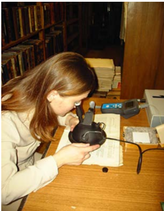
Рис. 2. Установка фотометрического шара на участок документа
