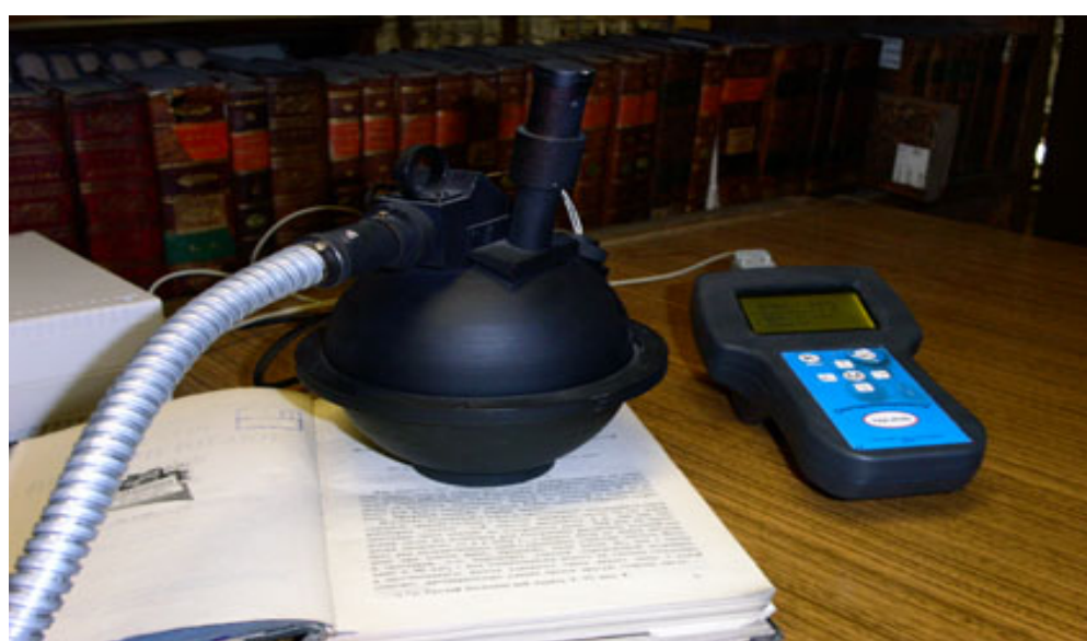
Рис. 3. Положение фотометрического шара на документе в процессе измерений
