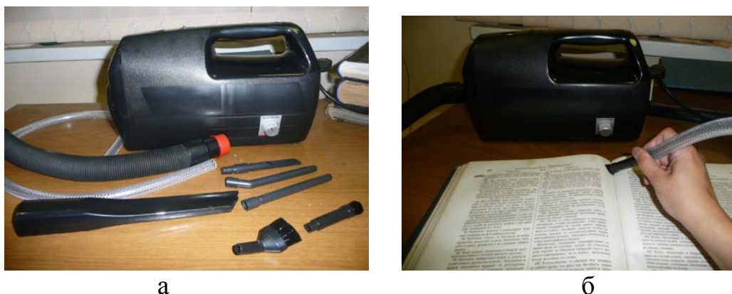
Рис. 3. Музейный пылесос MUNTZ 555: а — пылесос с насадками, б — обеспыливание книги
