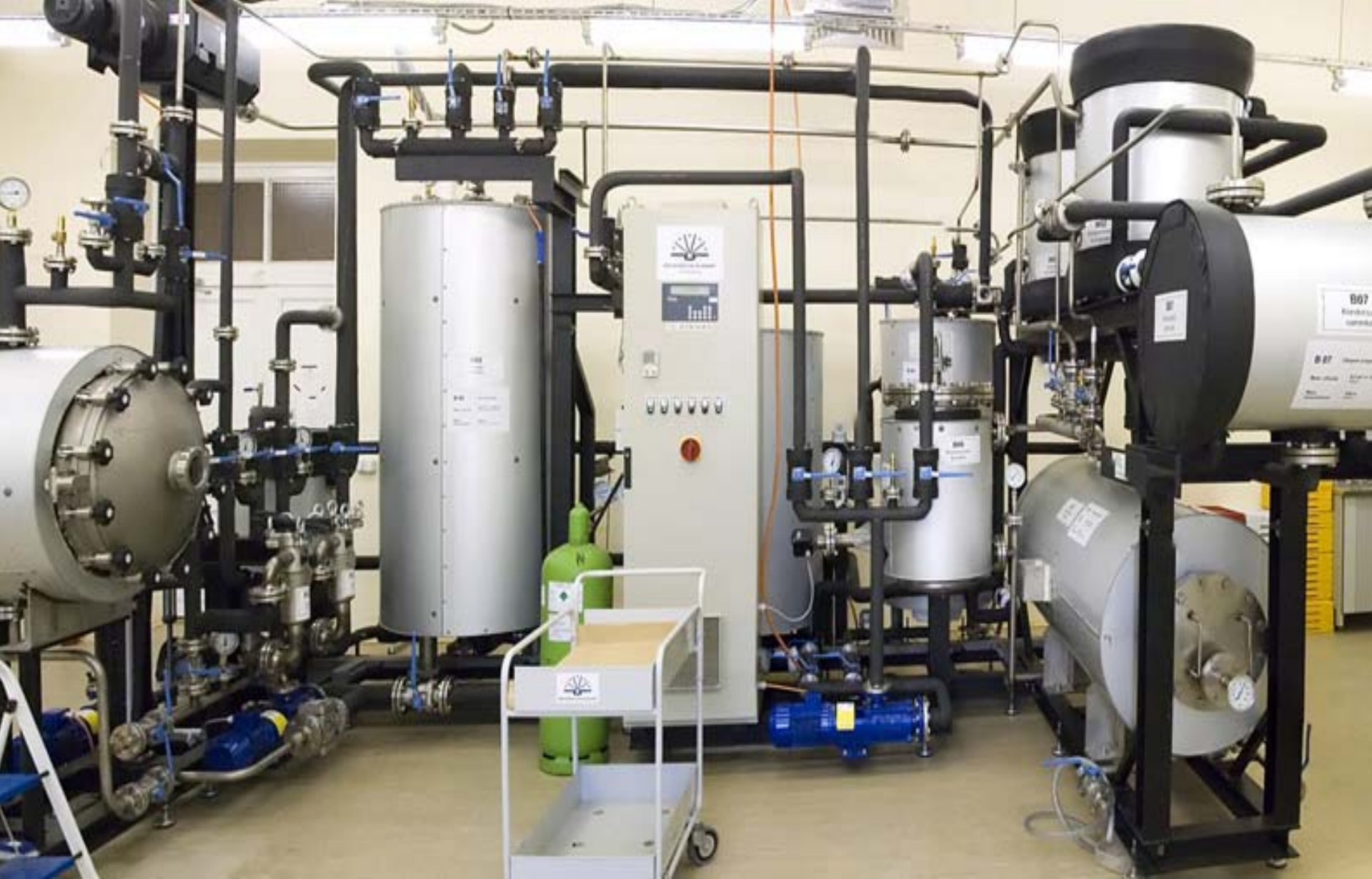
Федеральный центр консервации библиотечных фондов. Установка для массовой нейтрализации кислотности бумаги книг
