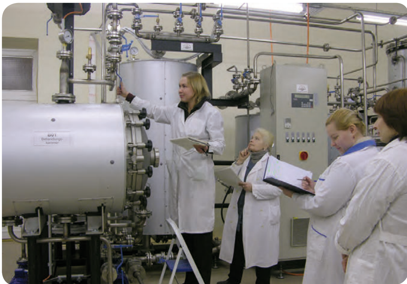
Оборудование для массовой нейтрализации кислотности бумаги в Федеральном центре консервации библиотечных фондов
